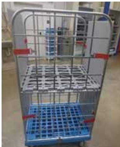
Durch diese neu entwickelten Rollwagen, kann eine Ladungssicherung beim Transport ohne Umwicklung der Rollwagen mit Folie gewährleistet werden.
